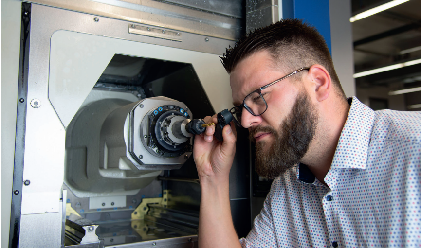
3 Prozesssicherheit geht vor: Christian Beer, Entwicklungsingenieur bei Emuge-Franken, prüft den Verschleißzustand eines Punch-Tap-Werkzeugs © Emuge-Franken
